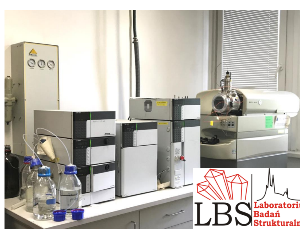
Wysokosprawny chromatograf cieczowy połączony z tandemowym spektrometrem mas
