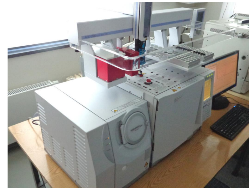
Chromatograf gazowy połączony ze spektrometrem mas
