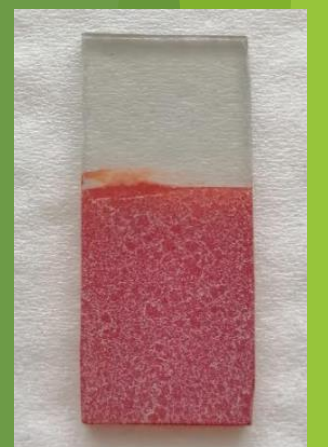
Rys. 2. Schemat wieloskładnikowego układu kompozytowego (od lewej) oraz rzeczywistego układu, którym na powierzchni szkła przewodzącego (FTO) elektrochemicznie osadzono tlenek miedzi(I) oraz napyłono zeolit TS-1 (od prawej).
