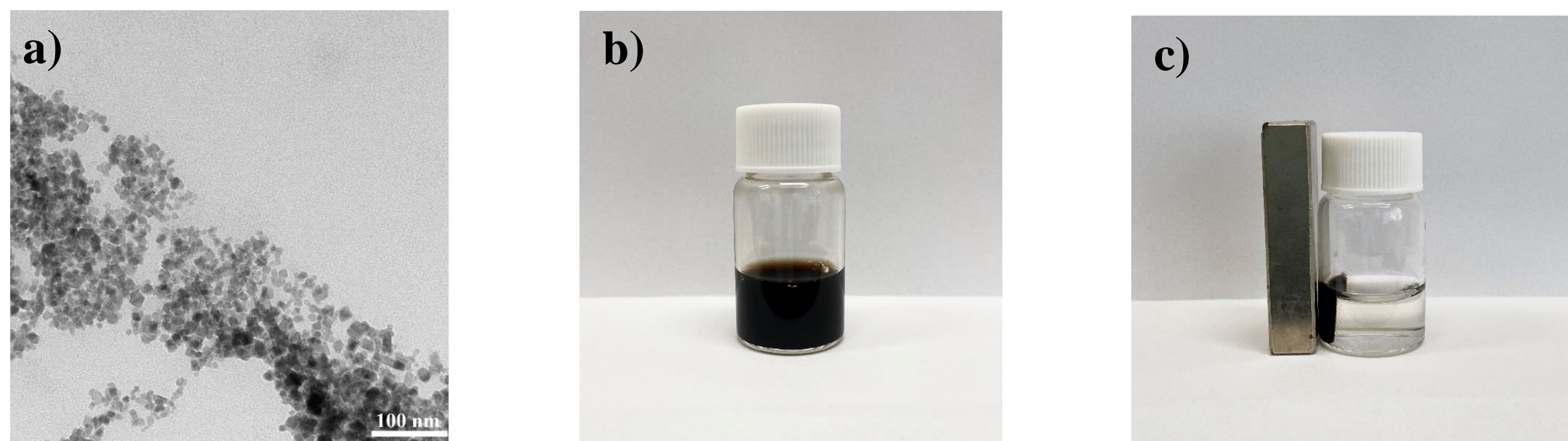
Rys. 1. a) Obraz TEM obrazujący uzyskane nanocząstki \text{Fe}_3\text{O}_4 , b) zdjęcie koloidalnego roztworu nanocząstek \text{Fe}_3\text{O}_4 bez magnesu, c) 10 sekund po przyłożeniu magnesu.
