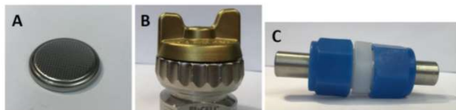
Nasze superkondensatory : prototyp w obudowie monetowej CR2032 (A) oraz pomiarowe układy laboratoryjne (B, C)
